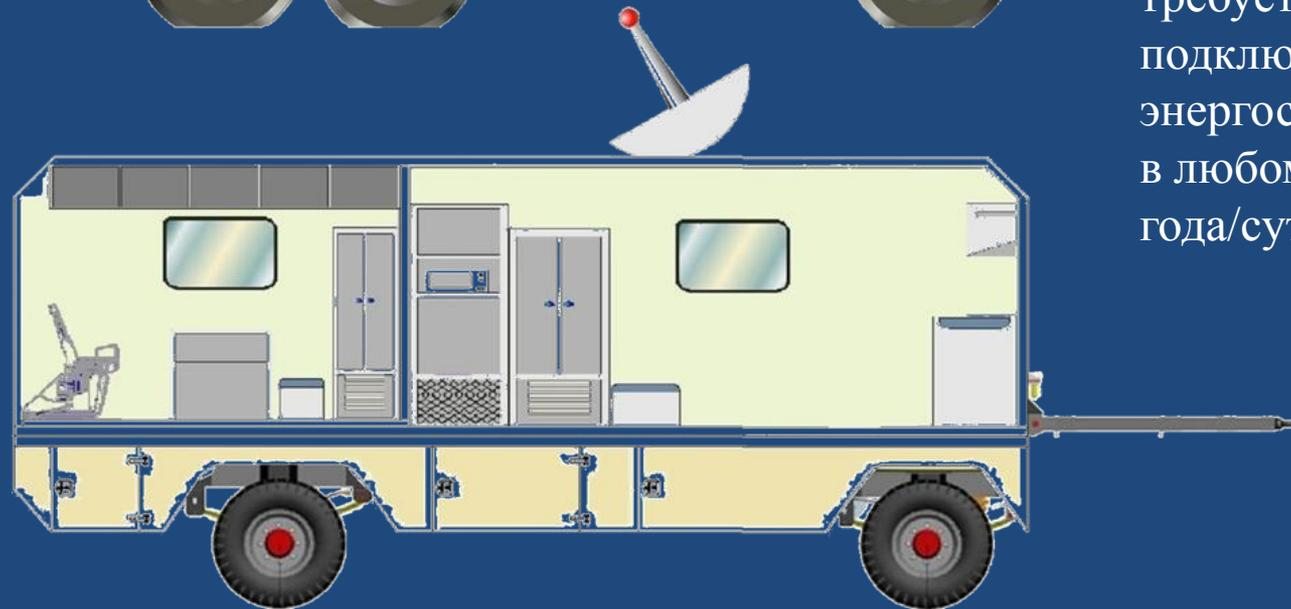
Благодаря встроенному инвертору 24В/220 В. с дополнительными аккумуляторными батареями, баком с водой, дизель-генератору (инверторного типа), ПММК не требует дополнительного подключения к каким-либо энергосистемам и готов к работе в любом месте и в любое время года/суток.
